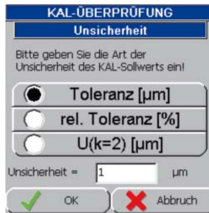
Abb. 2: Beispiel der Anzeige des FMP100 bei der Überprüfung der Kalibrierung. Hier: Eingabe der Folienunsicherheit
