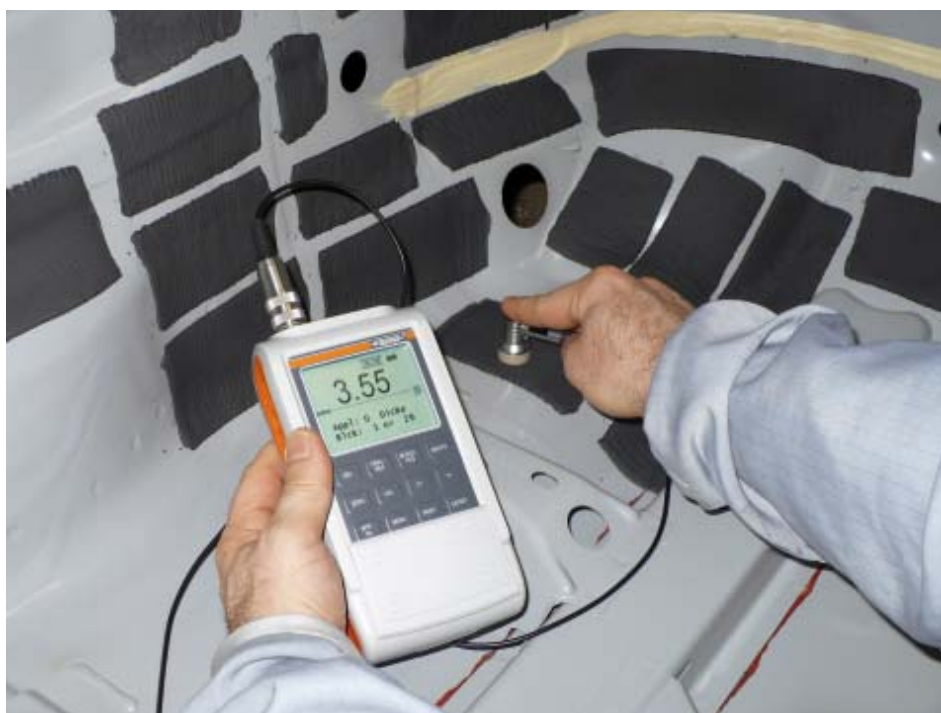
Sonde FA14 im praktischen Einsatz beim Messen der SAM-Schichten (Daimler AG, Mercedes-Benz Werk Bremen)
