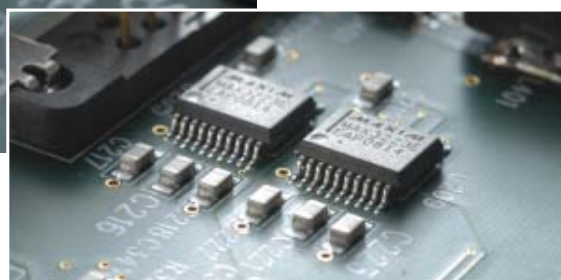
Abb. 1 zeigt verschiedene bestückte Leiterplatten. Die Lötstellen und Beschichtungen der elektronischen Baugruppen können zum Beispiel mit dem FISCHERSCOPE® XDAL® gemessen werden
