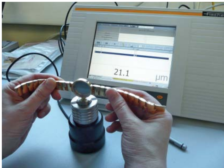
Abb. 3: FISCHERSCOPE® MMS®-PC2 mit Beta-Strahler und Messobjekt Uhrengehäuse (goldbeschichtet)
